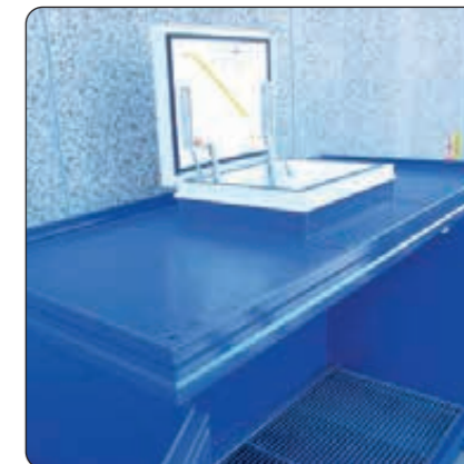
Botola da tetto in esecuzione, anti esplosione, certificata. Dimensioni mm. 700 x 900 Apertura automatica con sovrappressione superiore a 100 Kg.
