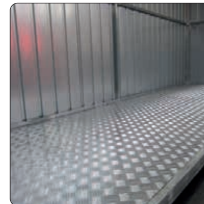
Piano di stoccaggio in alluminio mandorlato spessore 3 + 2
