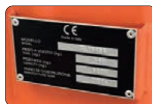
MARCATURA CE CE MARKING
