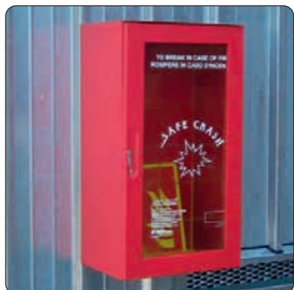
Cassetta porta estintori adatta ad estintori da 6 Kg polvere o similari. Costruita in lamiera e verniciatura con polvere epossipolistere. L'estintore non è incluso.
